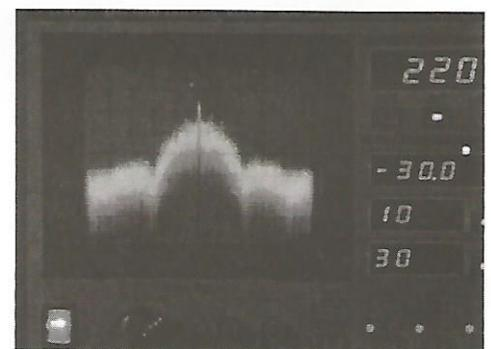
**Gambar 16 :** Luaran Rangkaian Penjumlah pada *Spectrum Analyzer*
