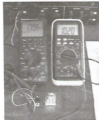
**Gambar 11 :** Set-up Pengukuran dengan  $E_i = 10,20$  V serta  $V_o = -13,06$  V
