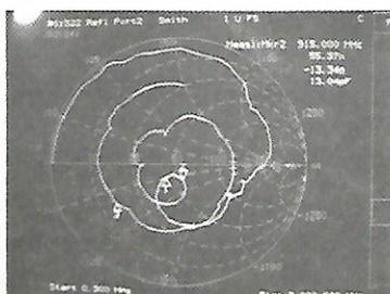
Gambar 11 : Grafik Hasil Pengukuran Impedansi Antena
