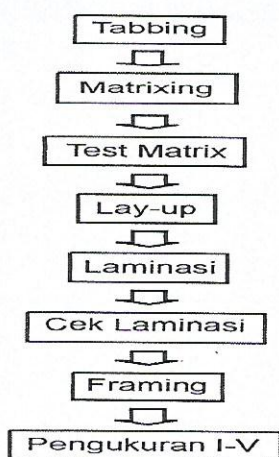
Gambar 2 : Proses Asembling Sel Surya
