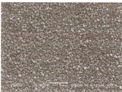
Gambar 4 : Morfologi Permukaan Lapisan Tipis ZnO Hasil DC Sputtering dengan waktu 1 jam dan Perbesaran 4000X
