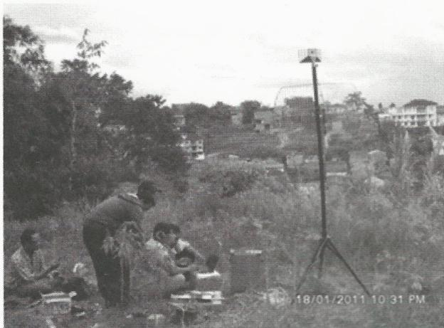
**Gambar 14:** Komputer pada sisi remote menerima data posisi sudut motor dan level pancaran antenna Radar
